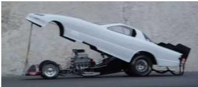
закрывает четыре колеса, поднимается целиком над шасси и не имеет боковых дверей, называется
